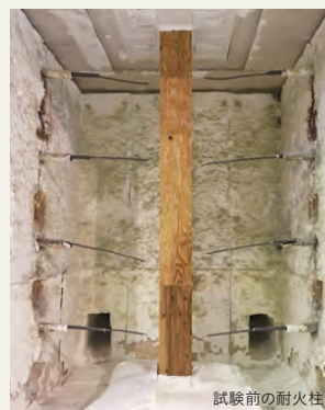
試験前の耐火柱
