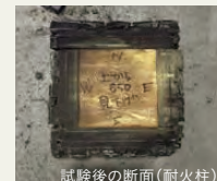
試験後の断面(耐火柱)
