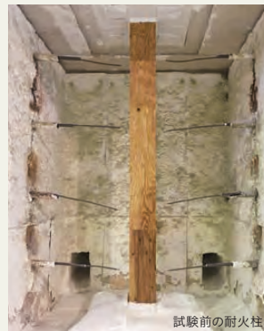
試験前の耐火柱
