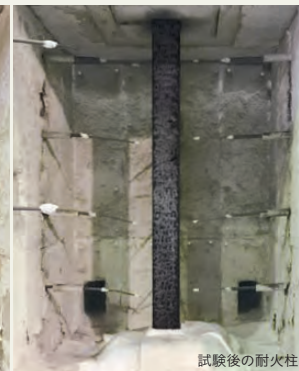
試験後の耐火柱
