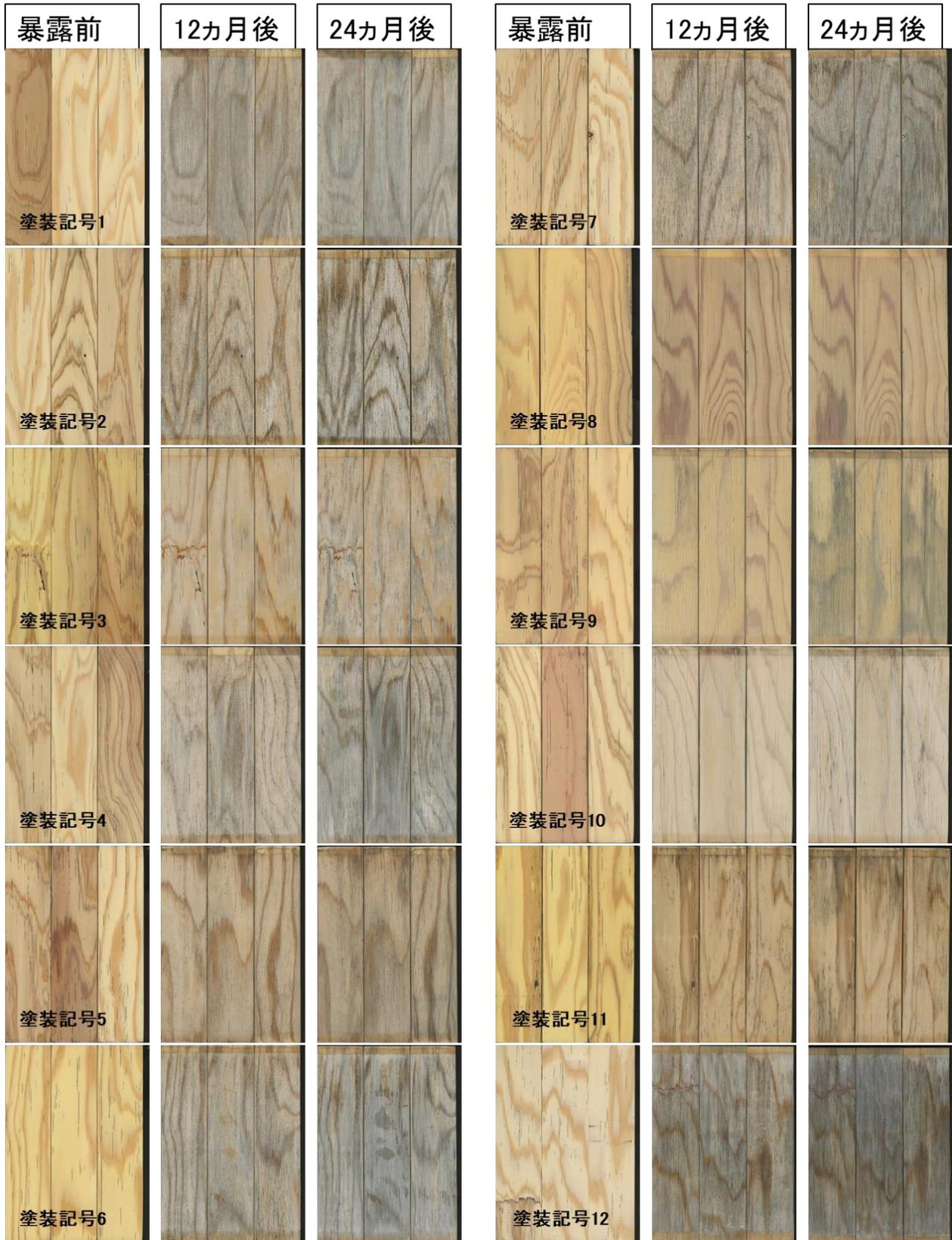
図 3-8 スギ LVL の屋外暴露 24 ヲ月間の外觀変化
