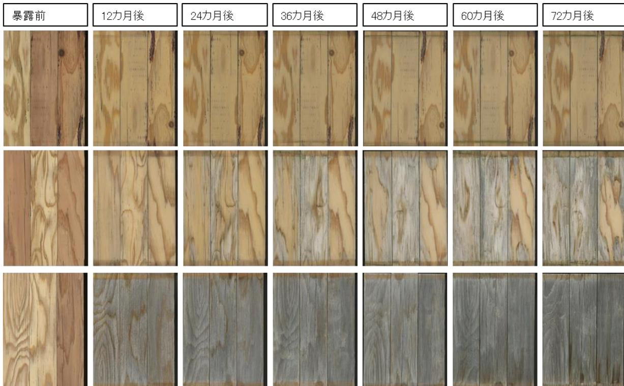
図 2-11 南向き 90 度暴露条件で 72 カ月間暴露したスギ LVL の単板面の塗装面の変化
