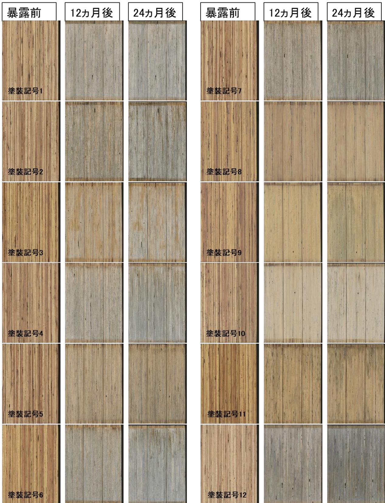
図 3-7 スギ LVL の屋外暴露 24 ヲ月間の外觀変化
