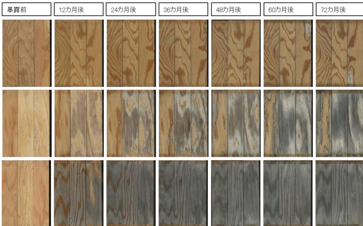
図 2-9 南向き 90 度暴露条件で 72 カ月間暴露したカラマツ LVL の単板面の塗装面の変化
