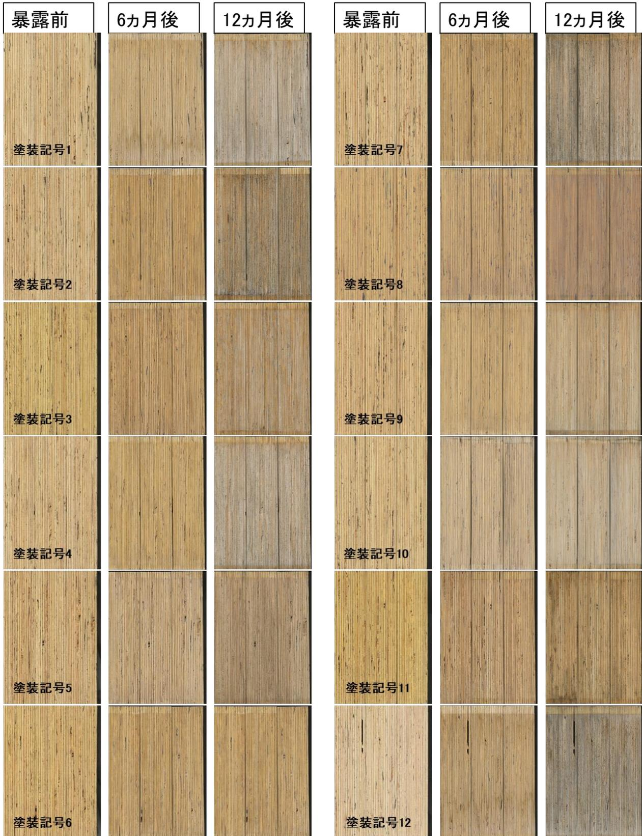
図 3-9 ラジアータパイン LVL の屋外暴露 12 ヶ月間の外観変化
