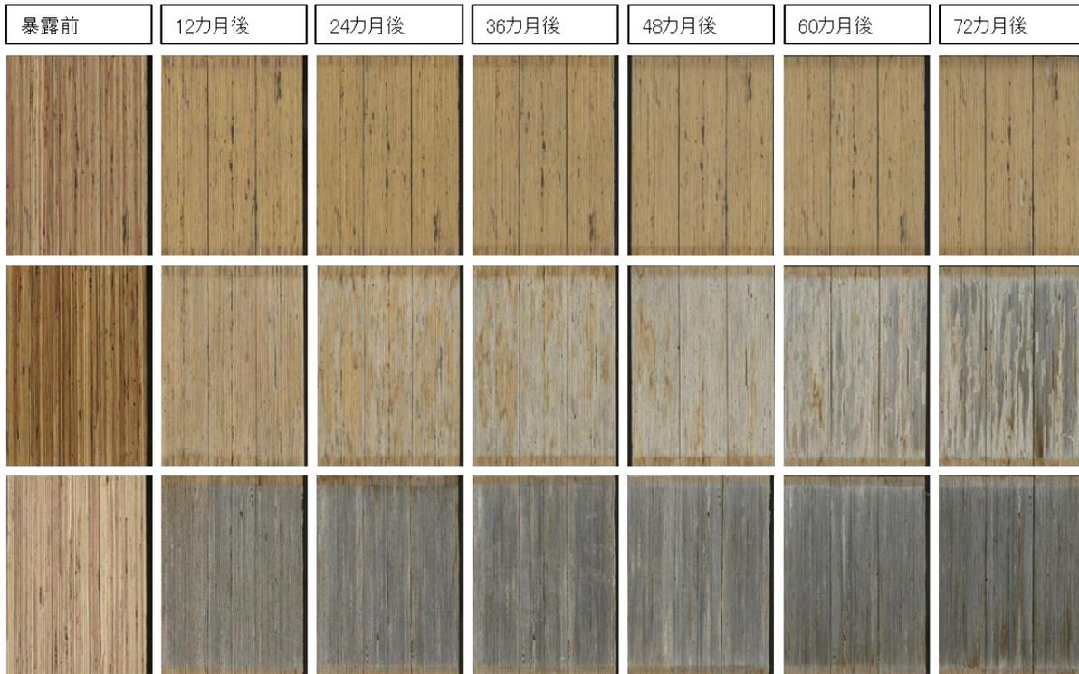
図 2-10 南向き 90 度暴露条件で 72 カ月間暴露したスギ LVL の積層接着面の塗装面の変化
