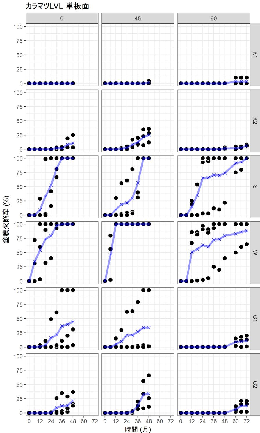
図 2-5 透明塗装した塗膜欠陥率の推移
