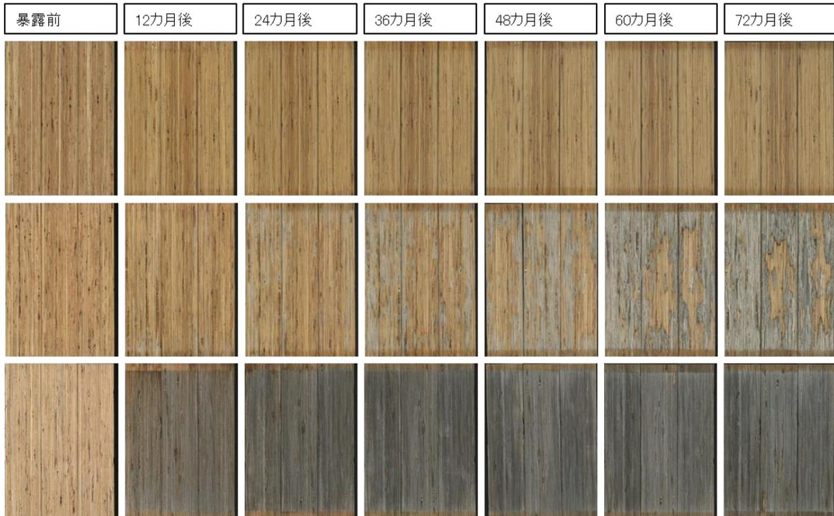
図 2-8 南向き 90 度暴露条件で 72 カ月間暴露したカラマツ LVL の積層接着面の塗装面の変化
