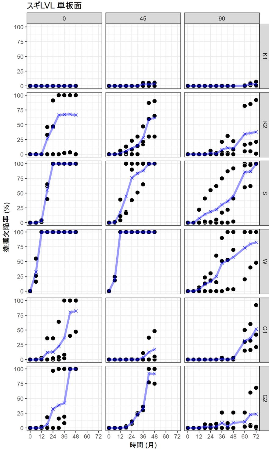
図 2-7 透明塗装した塗膜欠陥率の推移
