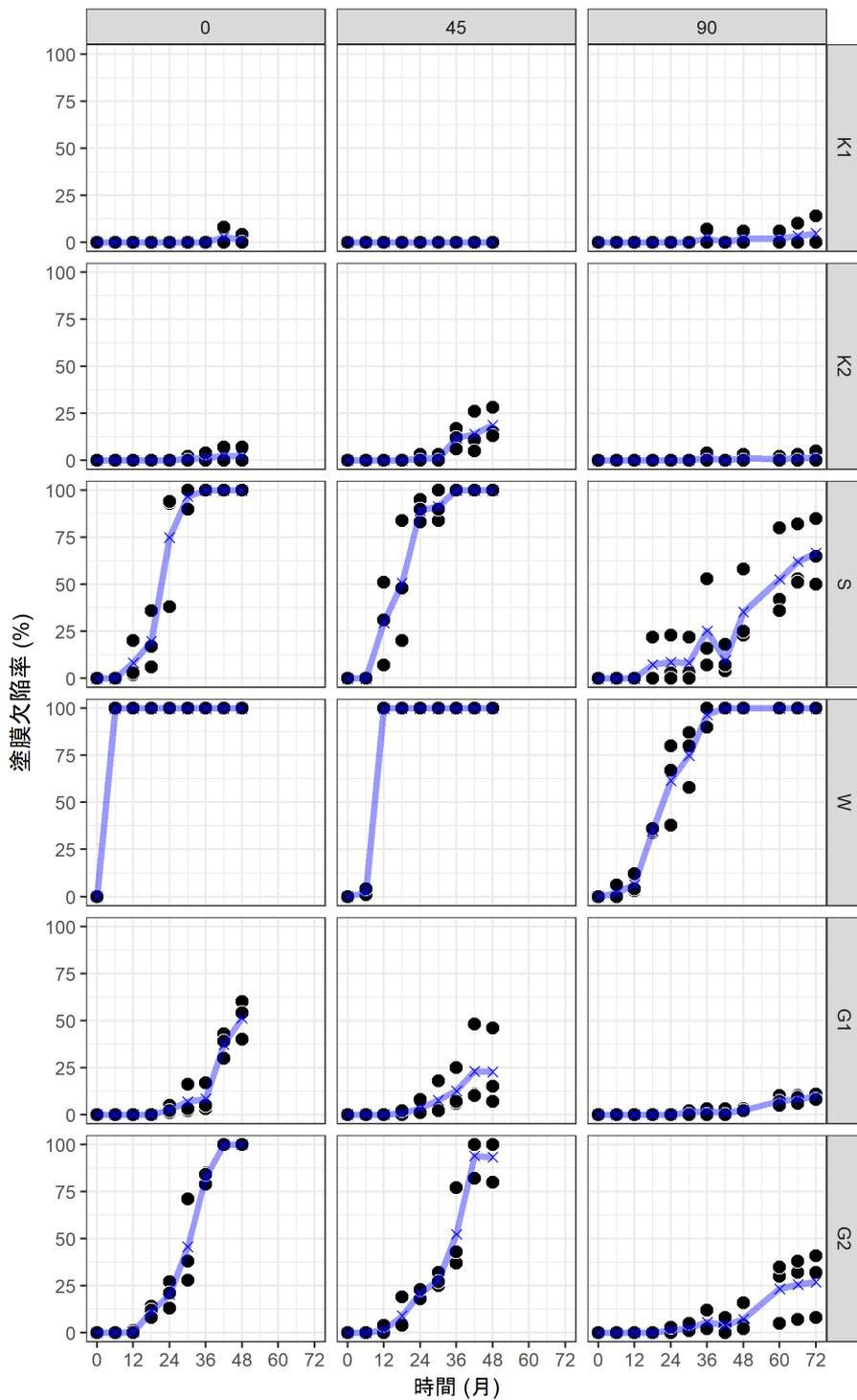
図 2-6 透明塗装した塗膜欠陥率の推移
