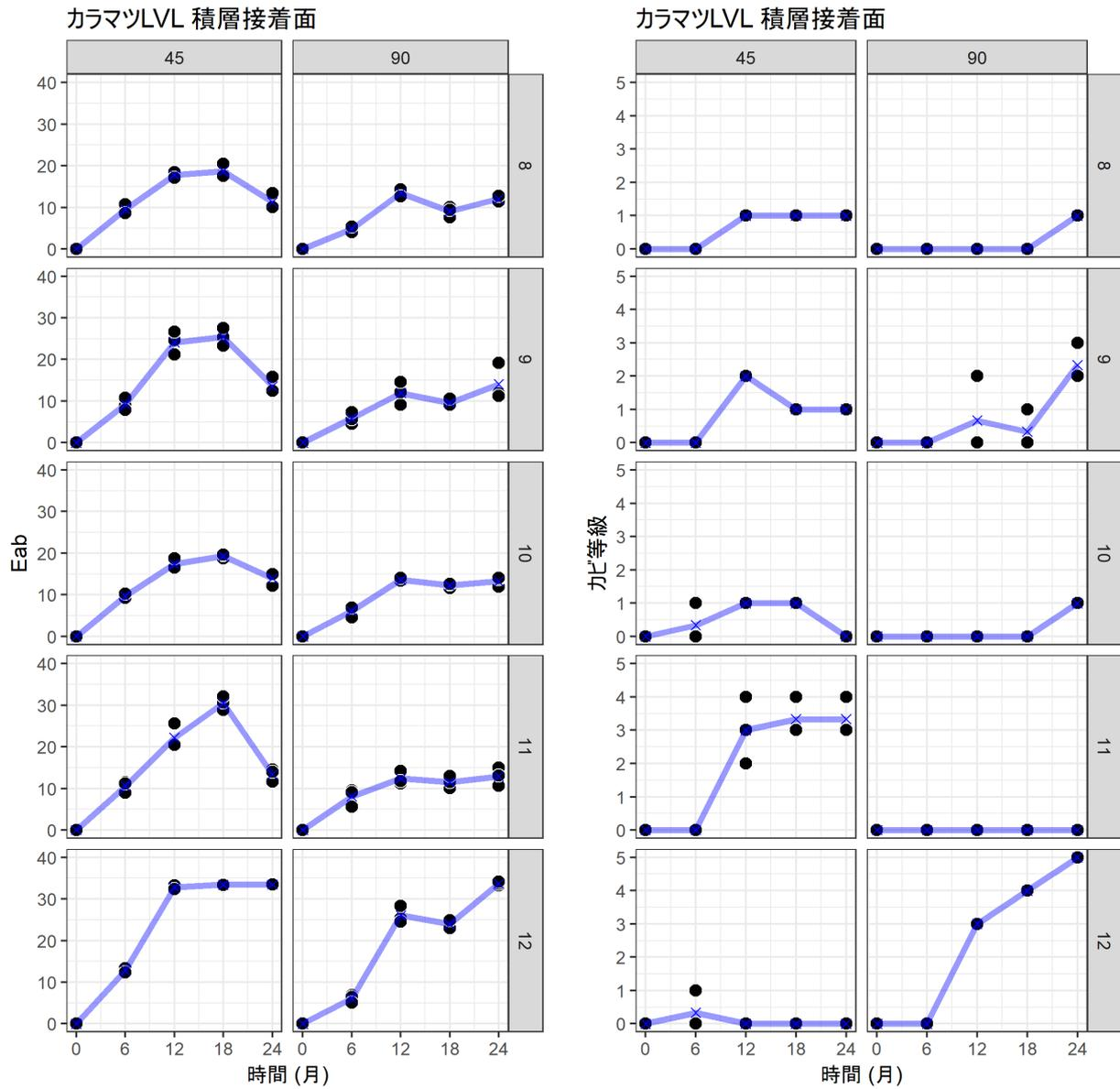
図 3-4 含侵形塗料を塗布した LVL と未処理 LVL の 24 カ月間の色差変化とカビ等級の変化
