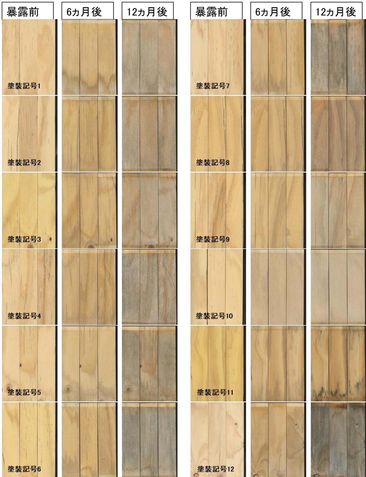
図 3-10 ラジアータパイン LVL の屋外暴露 12 ヶ月間の外観変化
