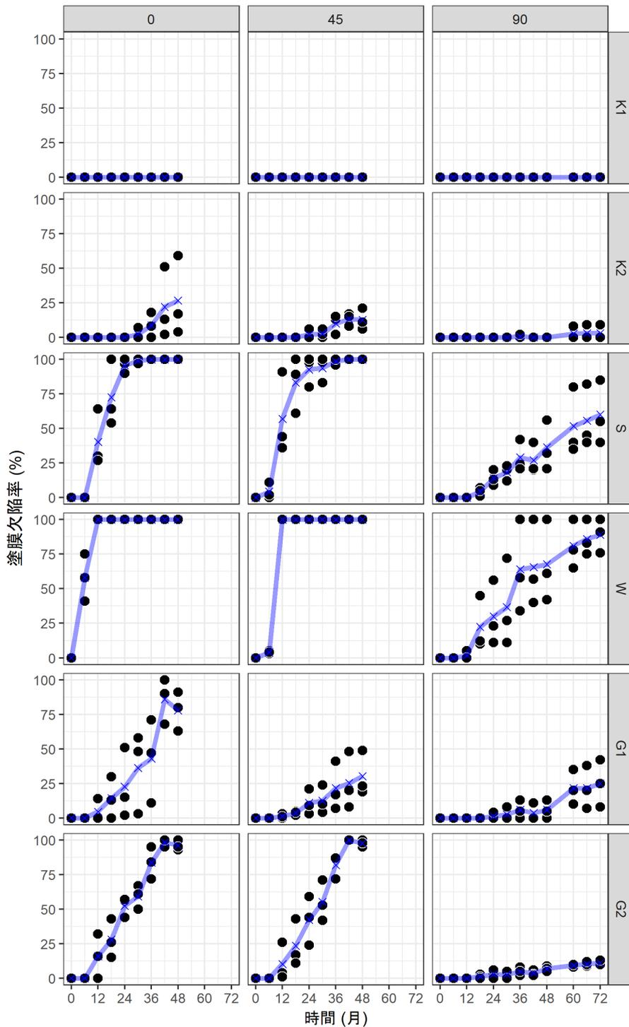
図 2-4 透明塗装した塗膜欠陥率の推移
