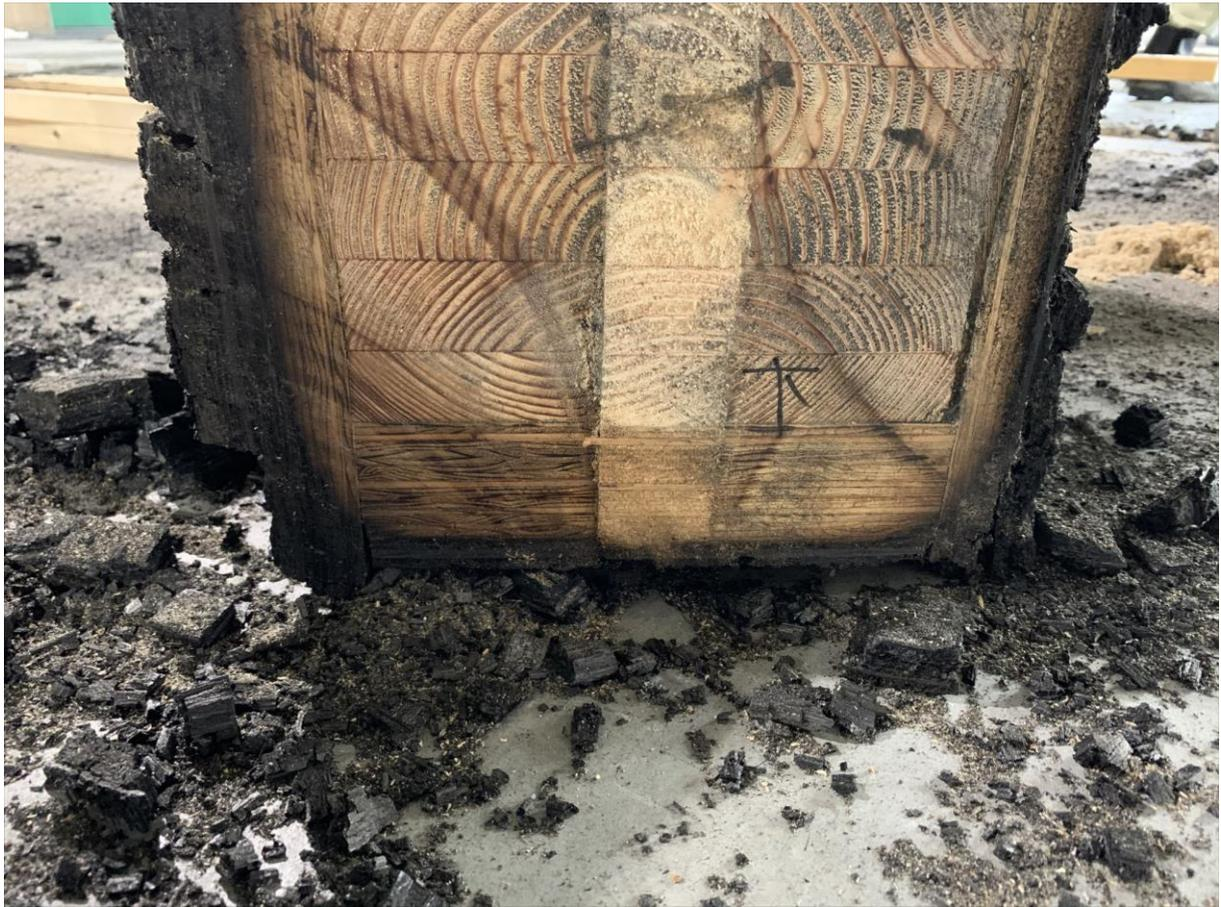
写真 4-21 被覆材断面（載荷点直下）
