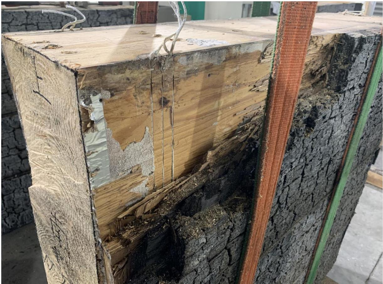
写真 4-26 被覆材を剥がした梁表面（南側）
