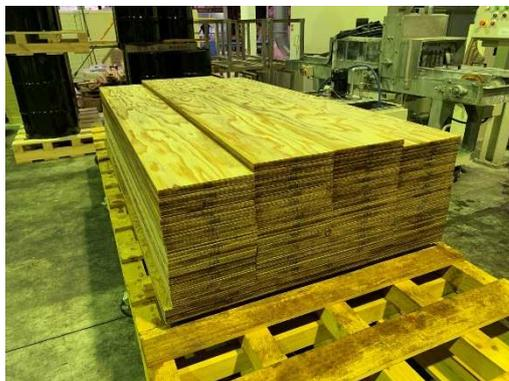
写真 3.1.12 乾燥釜に投入されるLVL
