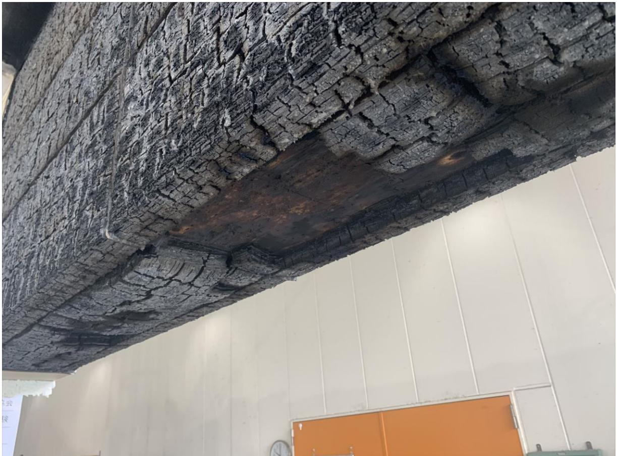
写真 4-14 被覆材下面脱落
