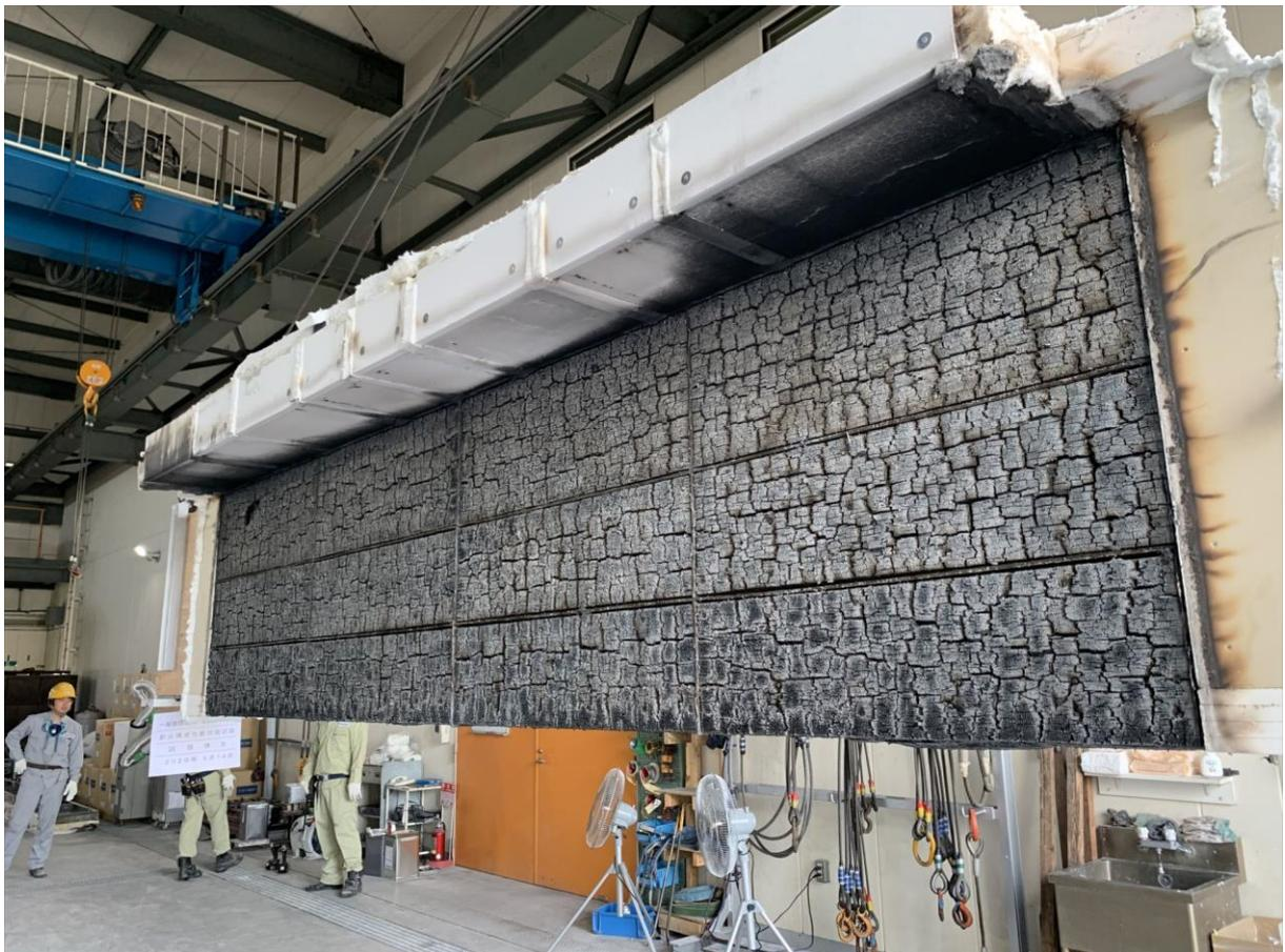
写真 4-12 脱炉 被覆材東側
