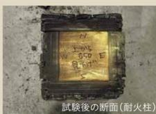
試験後の断面（耐火柱）
