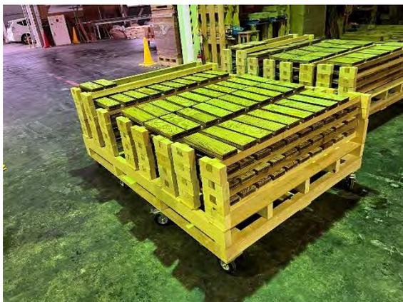
写真 4. 3-3 発熱性試験試験体
