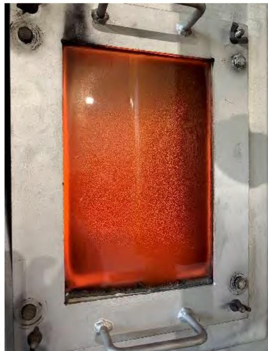
写真 3.3.8 開始 65 分 薬剤による窓の汚れ
