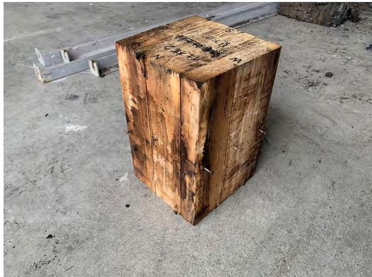
写真 3. 2. 22 柱表面 N側は最大280度近くまで上昇
