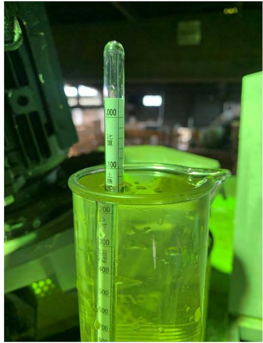
写真 3.1.2 比重計による難燃薬剤の濃度確認
