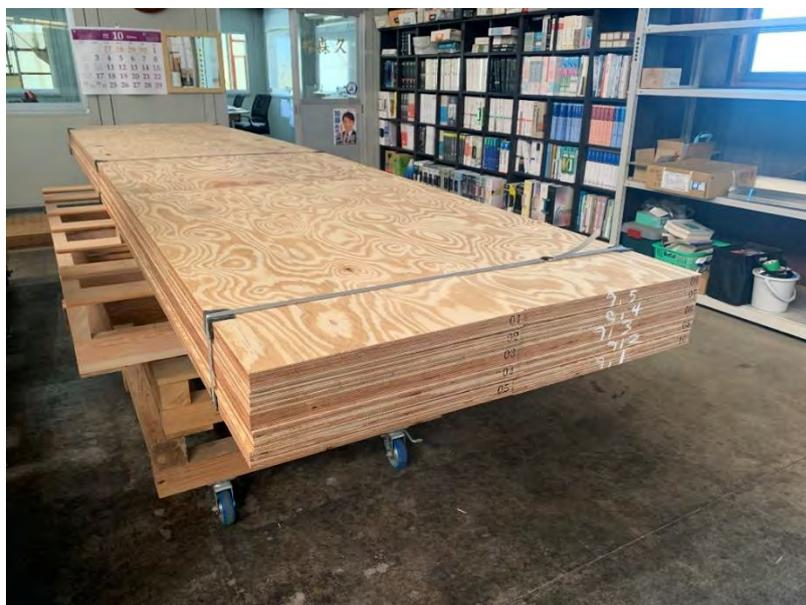
写真 4. 1-2 スギ単板積層材(幅 455mm)
