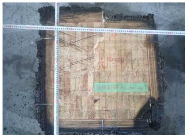
写真-12 試験体A 高さ1000mm付近の断面
