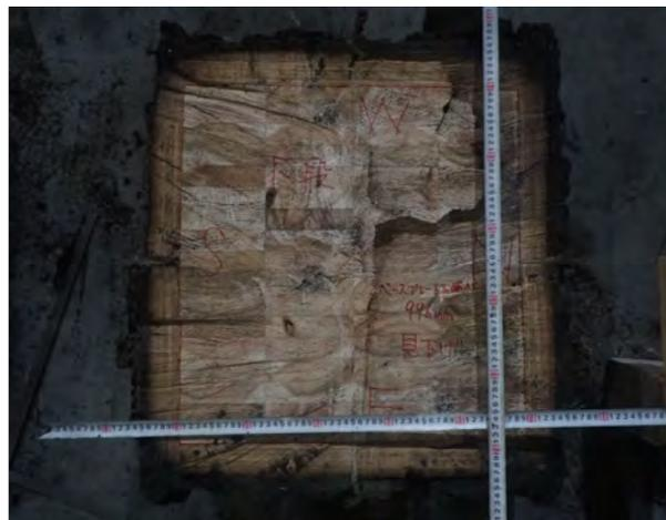
写真-12 試験体A 高さ1000mm付近の断面
