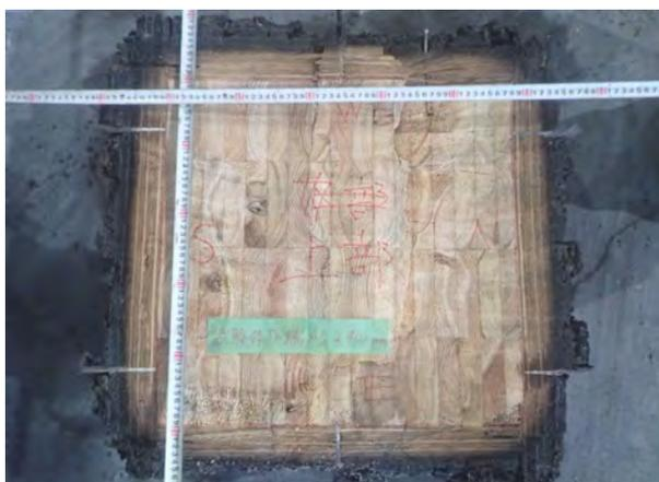
写真-9 試験体A 高さ2400mm付近の断面
