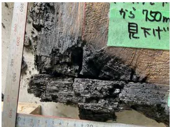
写真 3. 2. 16 仕様 2 上段 (熱電対) 炭化部
