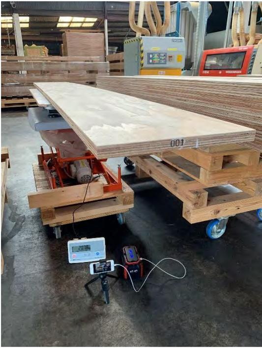
写真 3.1.1 含浸前重量測定
