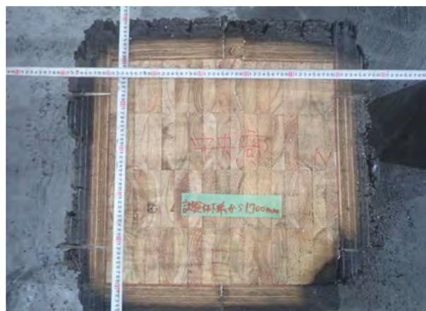
写真-10 試験体A 高さ1700mm付近の断面
