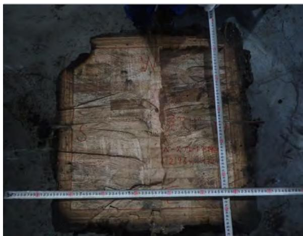
写真-10 試験体A 高さ2200mm付近の断面
