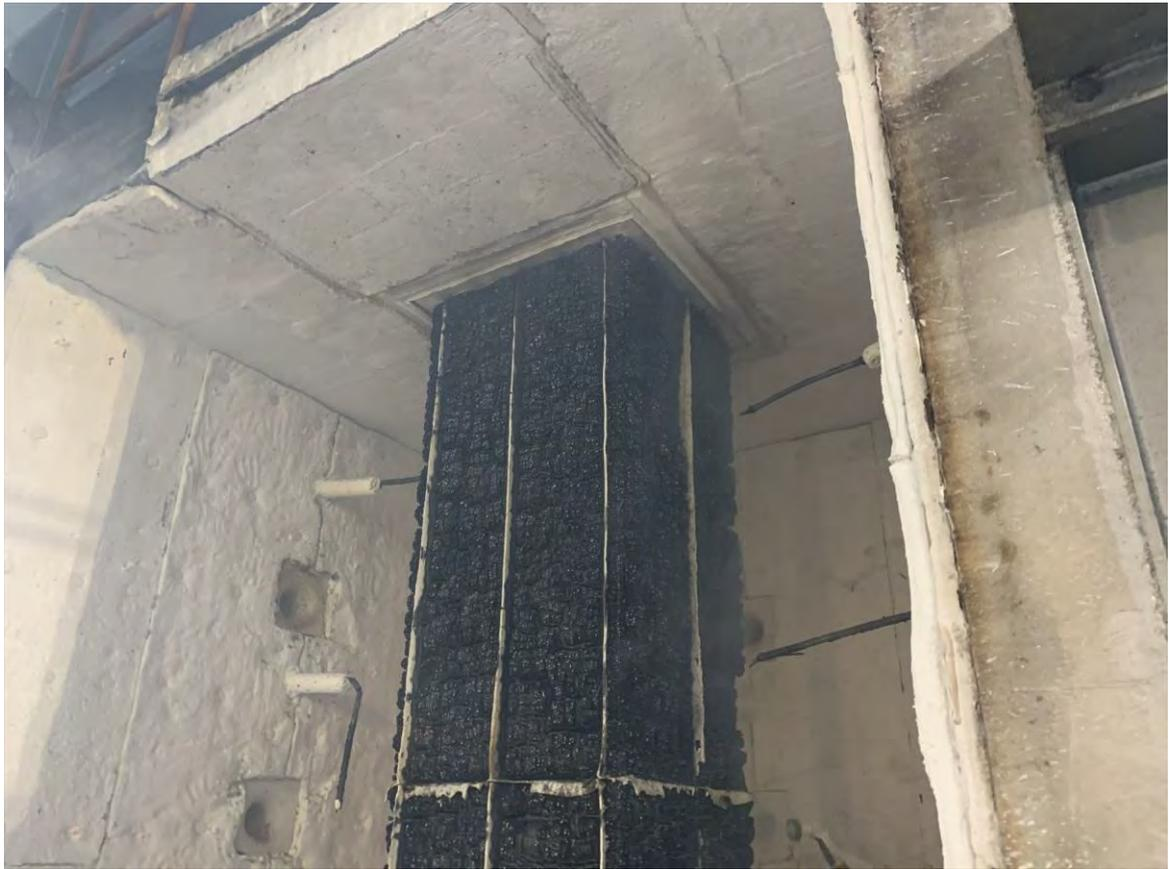
写真 3.3.10 試験体上部 消火後
