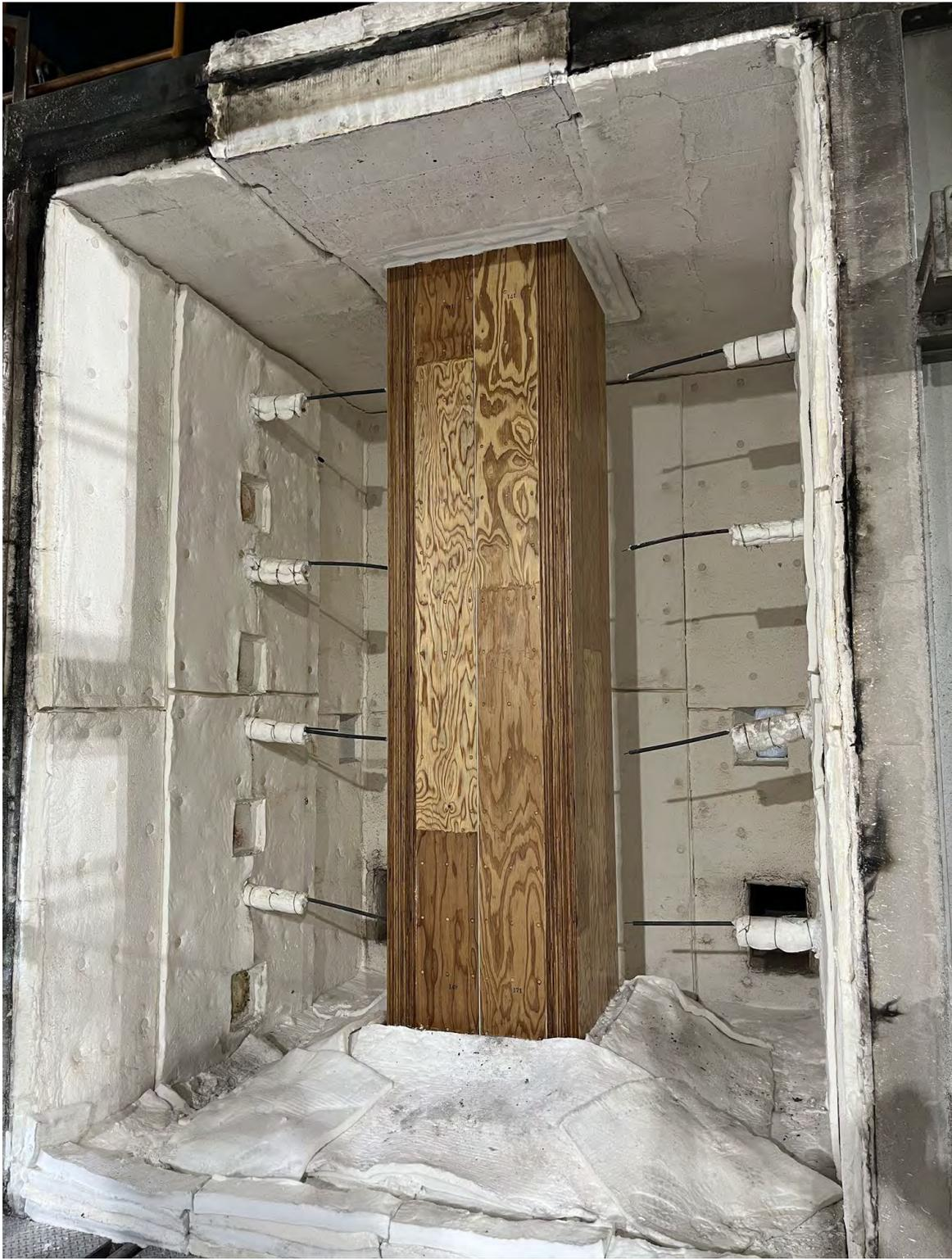
写真 3.5.2 試験体（加熱前）
