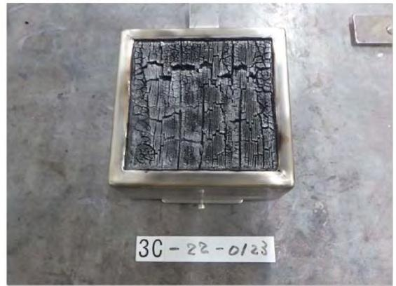
写真 4.2-5 試験体 B 試験後
