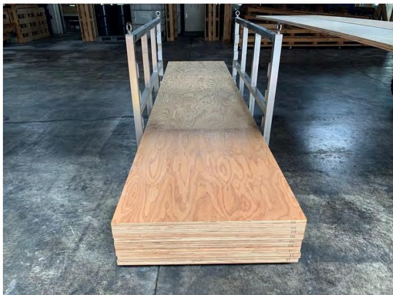
写真 4. 1-1 スギ単板積層材(幅 910mm)
