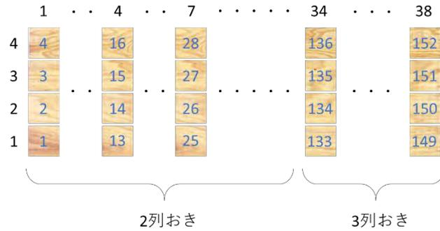
図 4. 1-16 小試験体の選択
