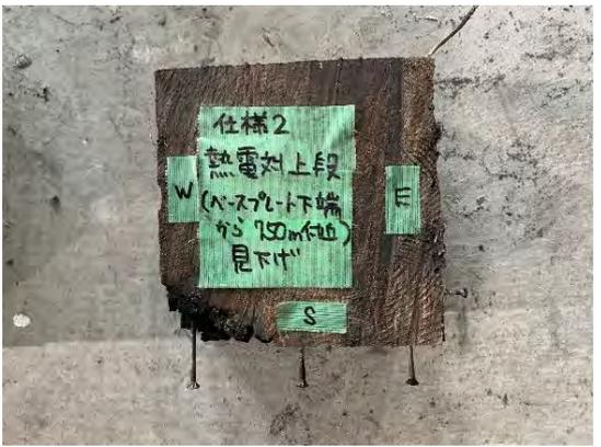
写真 3. 2. 17 仕様 2 上段炭化部 断面
