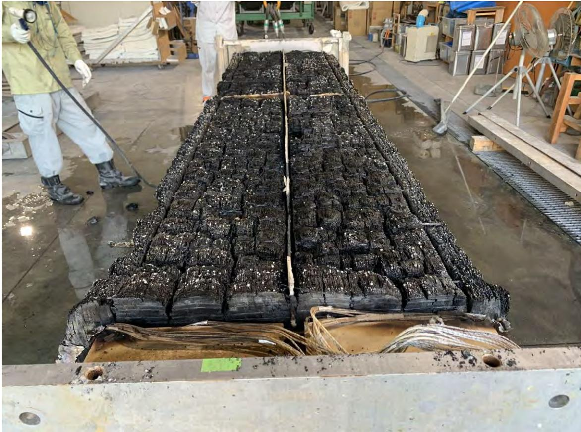
写真 3.3.12 表面の無処理LVLはほぼ脱落 処理LVL表面に薬剤が白く析出
