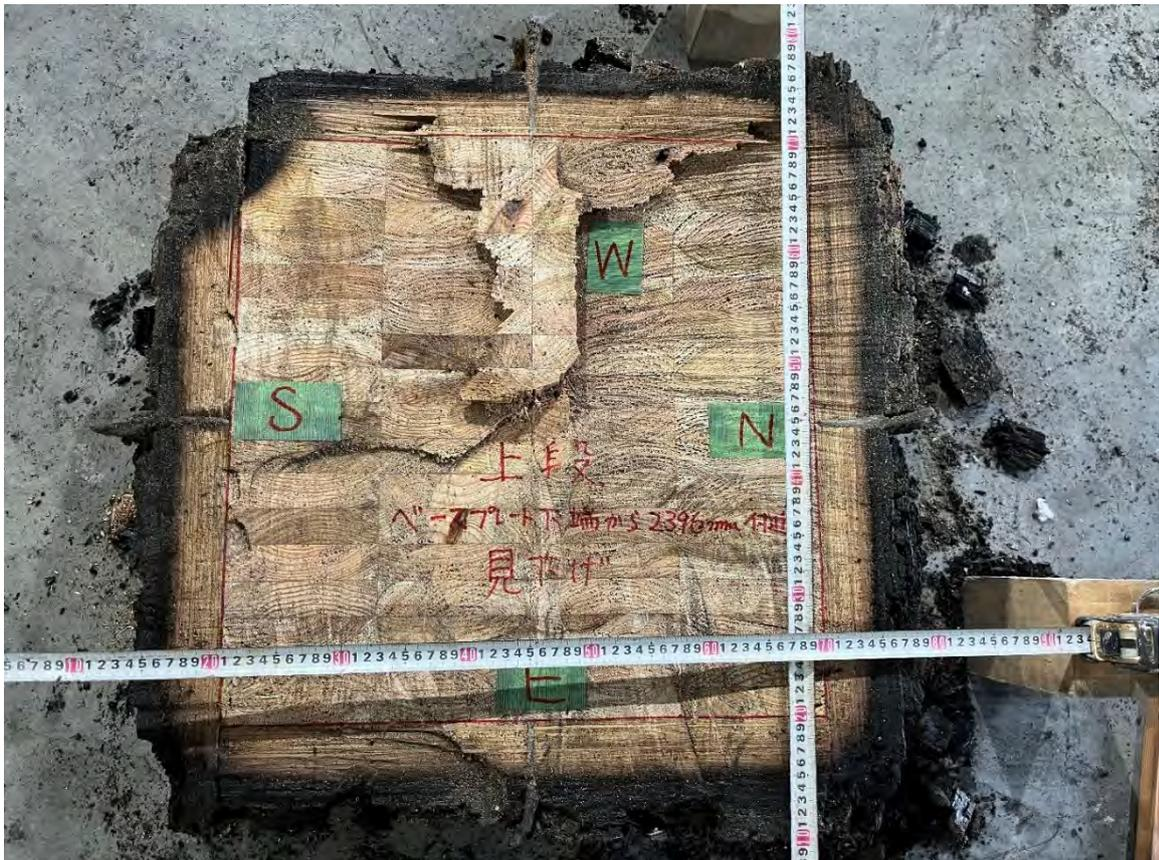
写真 3.4.19 断面（上段） 左上燃え込み
