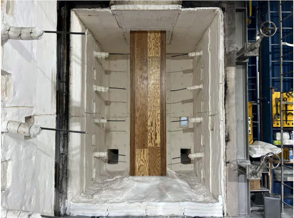
写真 3.4.7 試験体 (加熱前)
