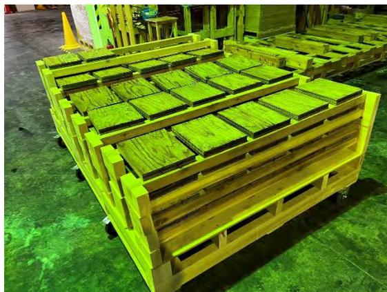
写真 4. 3-4 ガス有害性試験体
