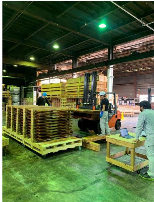
写真 3.1.4 含浸後重量測定
