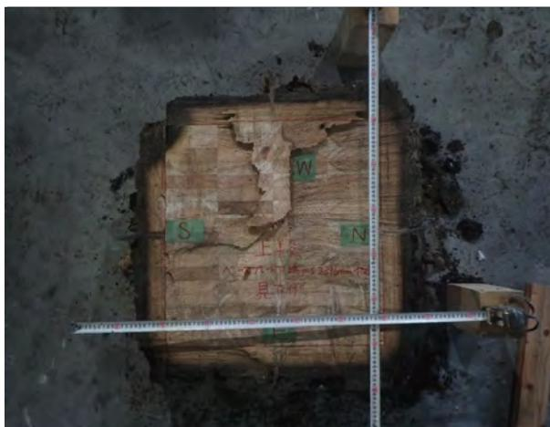
写真-9 試験体A 高さ2400mm付近の断面
