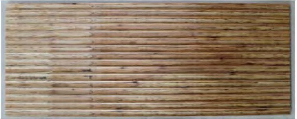
写真 5. 板目面×曲面加工へのクリア塗装
