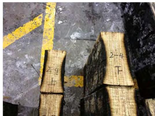
写真 5. 1. 3-12 試験体②-4 炭化状況
