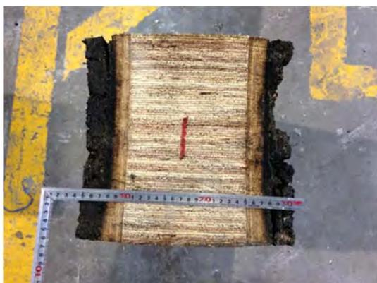
写真 5. 1. 3-5 試験体①-1 炭化状況
