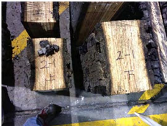
写真 5. 1. 3-9 試験体②-1 炭化状況
