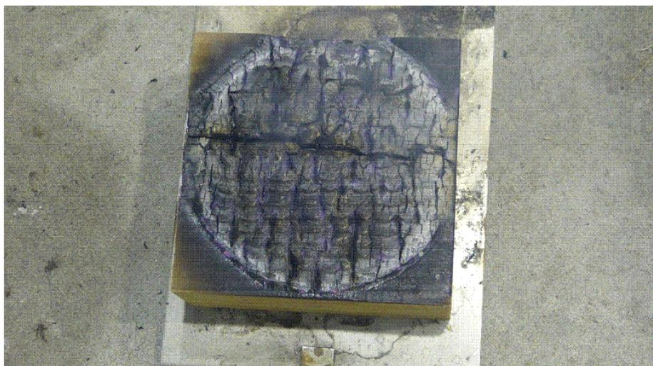
写真7 板目材の燃焼
