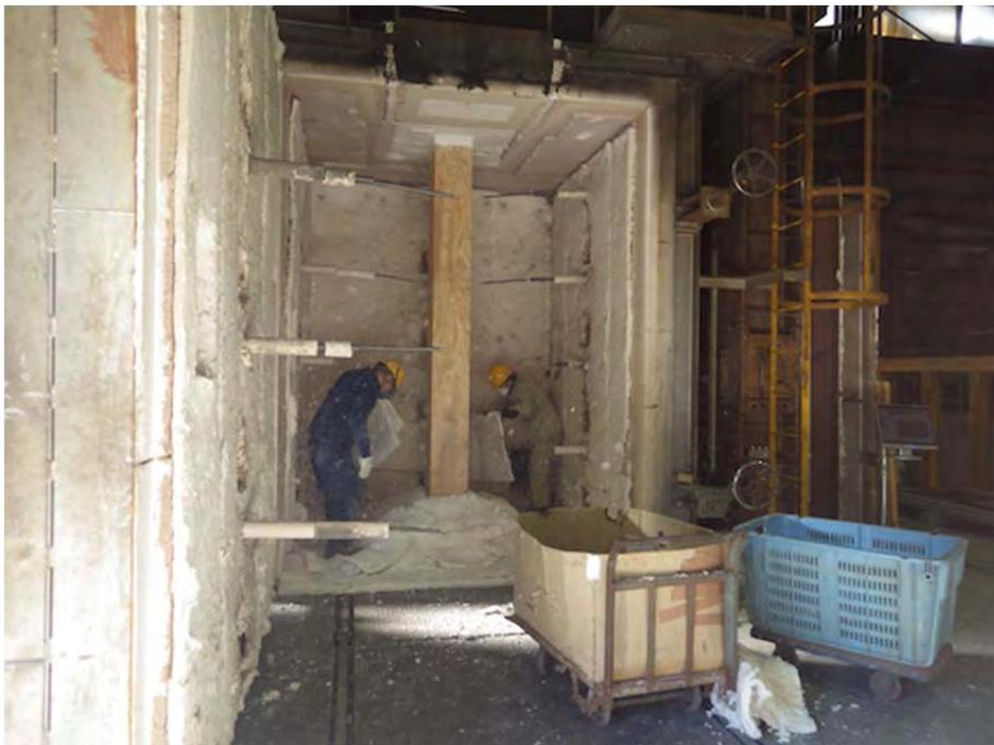
写真 2.2 建物一層分の長さの柱による載荷加熱実験の試験体と耐火炉の様子
