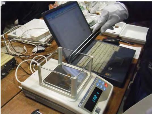
写真 1.3 小試験片の重量測定状況 1
