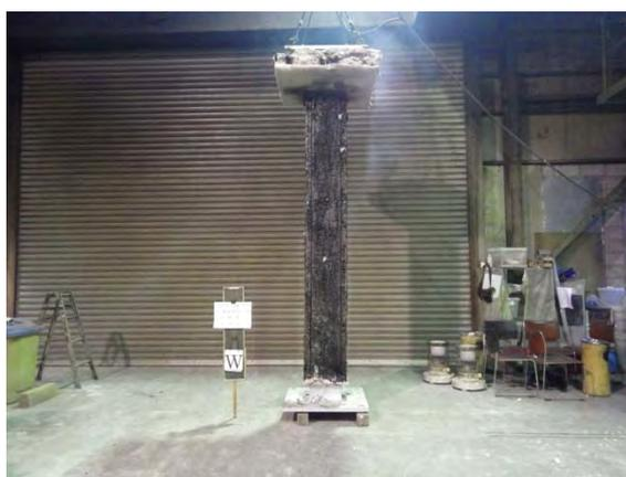
写真 6. 3-4 加熱放置終了後の試験体の様子②
