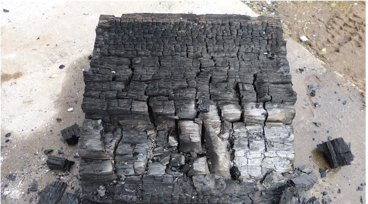
写真 19 試験体 B-CS600PL-L (積層面加熱) における脱炉後の状況
