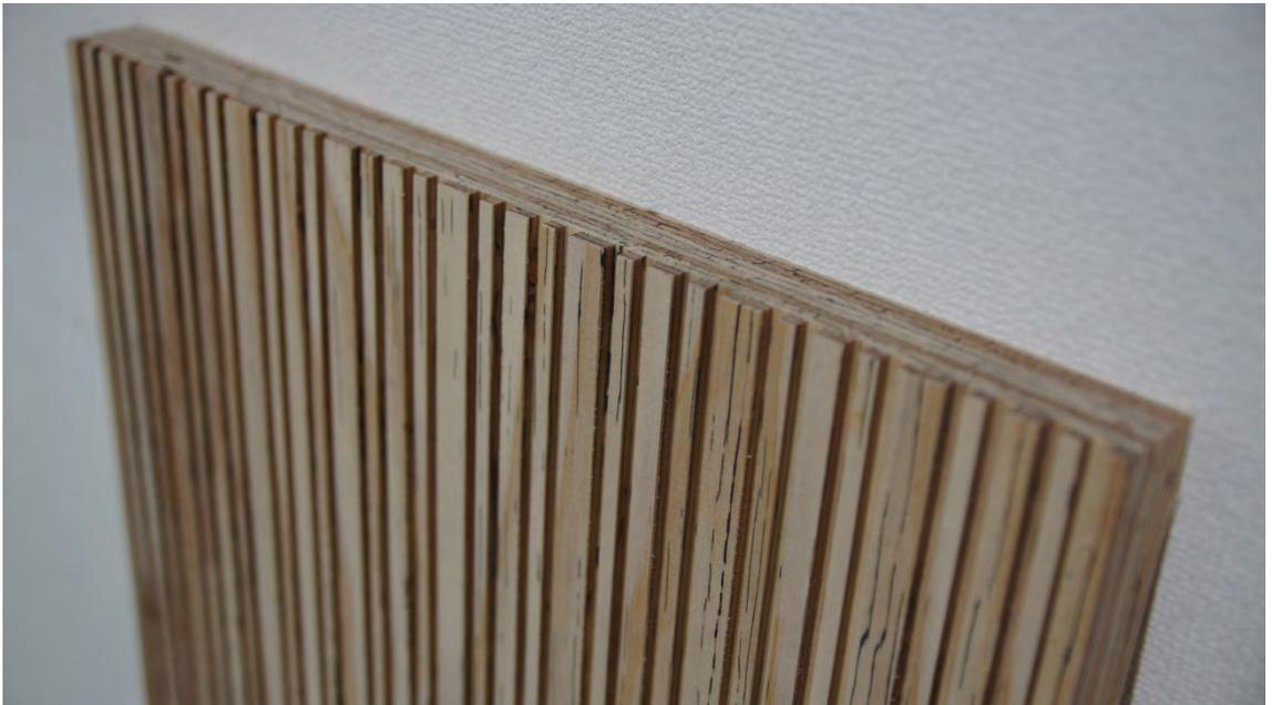
写真 16 板目面 凸凹加工
