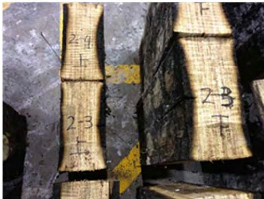
写真 5. 1. 3-11 試験体②-3 炭化状況
