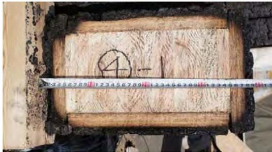
写真 5. 2. 3-9 試験体④-1 炭化状況
