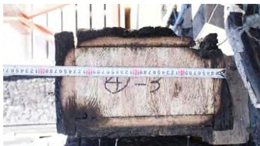
写真 5. 2. 3-11 試験体④-3 炭化状況
