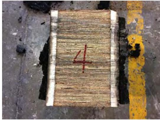
写真 5. 1. 3-8 試験体①-4 炭化状況
