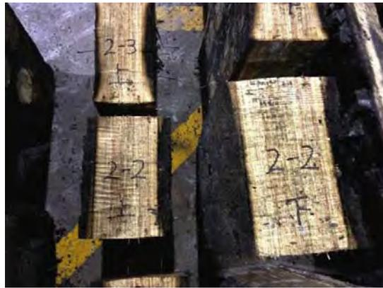
写真 5. 1. 3-10 試験体②-2 炭化状況
