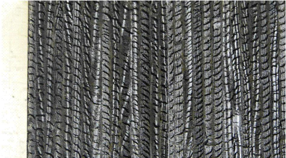
写真 14 LVL 木口面の燃焼(1)
