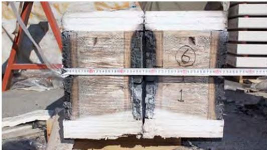
写真 5. 1. 3-17 試験体⑥-1 炭化状況
