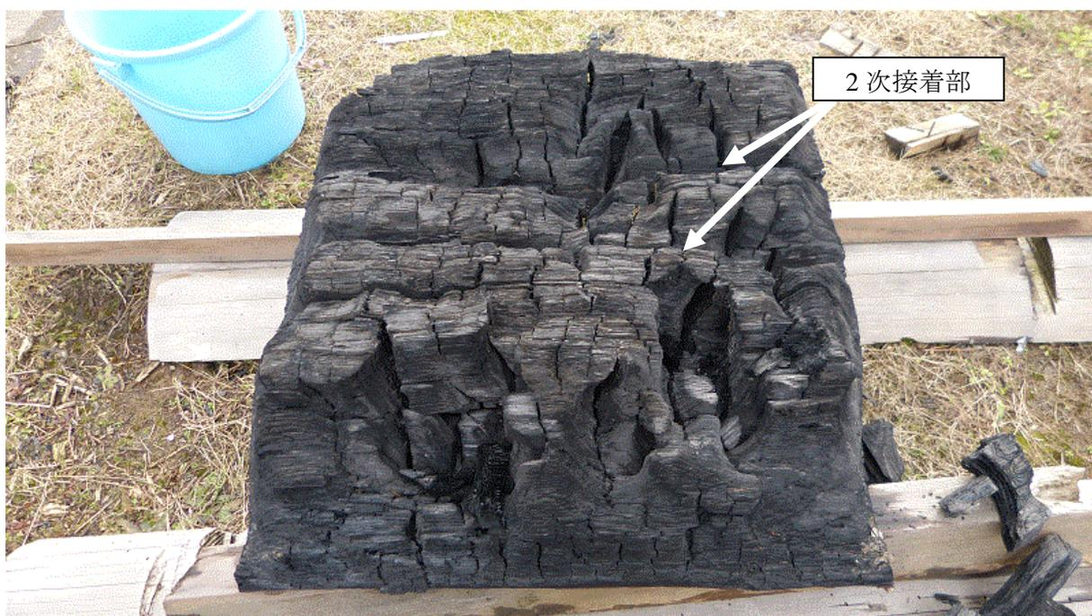
写真 17 試験体 B-CL600PL-L (積層面加熱) における脱炉後の状況
