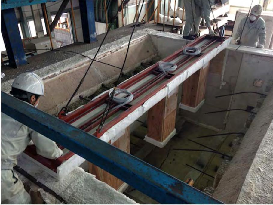
写真 2.1 短柱による加熱実験の試験体と耐火炉の様子
