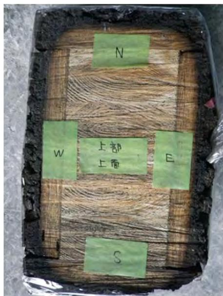
写真 6. 3-6 試験体 B 炭化状況
