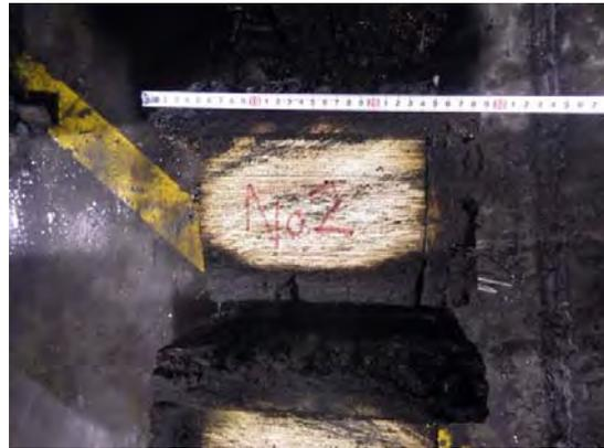
写真 5. 2. 3-8 試験体③-2 炭化状況
