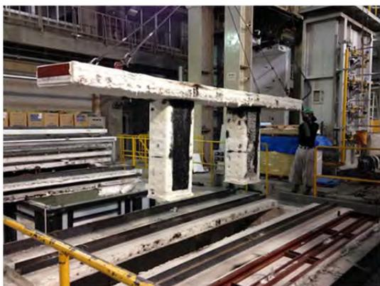
写真 5. 1. 3-3 加熱放置終了後の試験体の様子①
