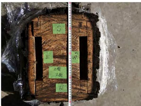
写真 6. 3-5 試験体 A 炭化状況
