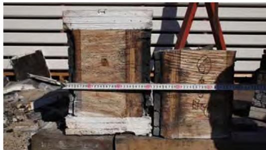
写真 5. 1. 3-19 試験体⑥-3 炭化状況
