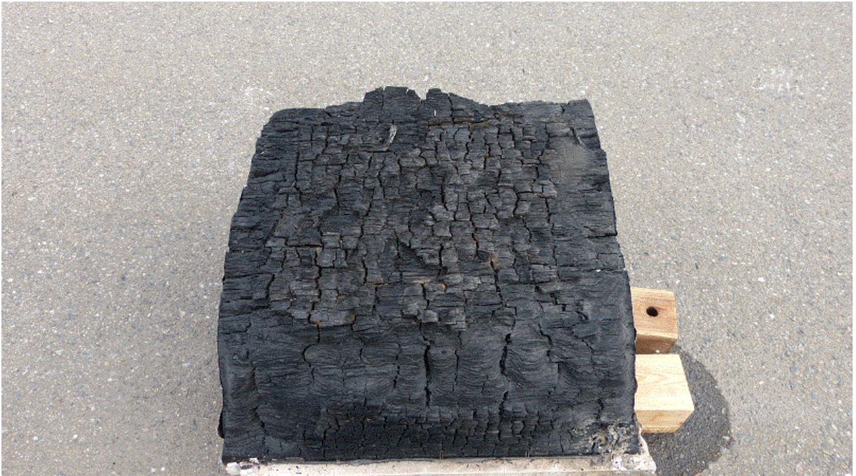
写真 18 試験体 B-CL600PL-G (板目面加熱) における脱炉後の状況
