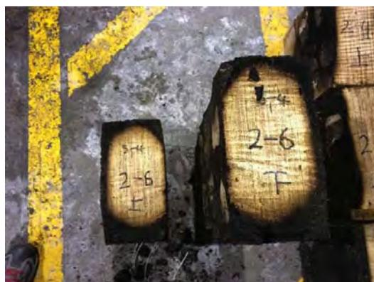
写真 5. 2. 3-6 試験体②-6 炭化状況
