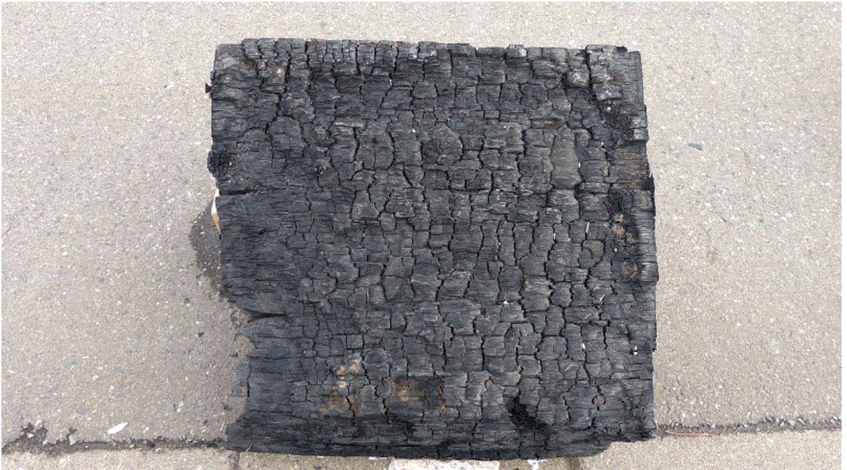
写真 20 試験体 B-CS600PL-G (板目面加熱) における脱炉後の状況
