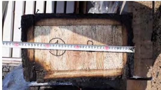
写真 5. 2. 3-10 試験体④-2 炭化状況
