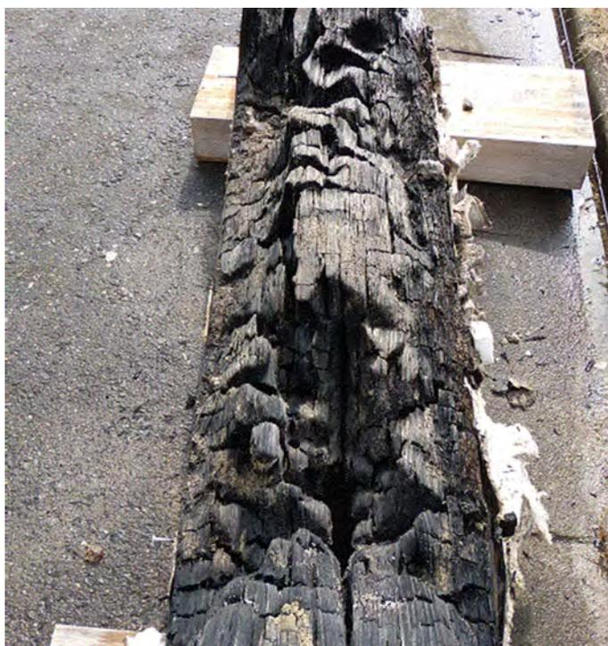
写真 23 試験体 C-CL210PL-L (積層面加熱) における脱炉後の状況
