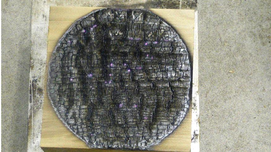
写真5 柁目に近い材の燃焼(3)
