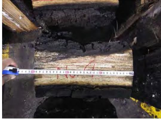
写真 5. 1. 3-14 試験体③-4 炭化状況
