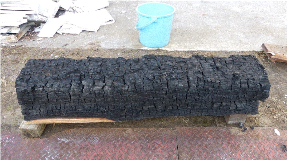
写真 24 試験体 C-CL210PL-G (板目面加熱) における脱炉後の状況
