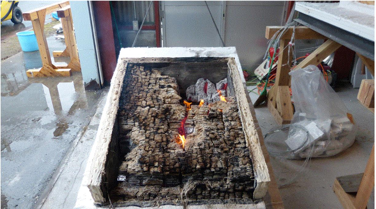
写真 22 試験体 B-CS900PL-G (板目面加熱) における脱炉後の状況
