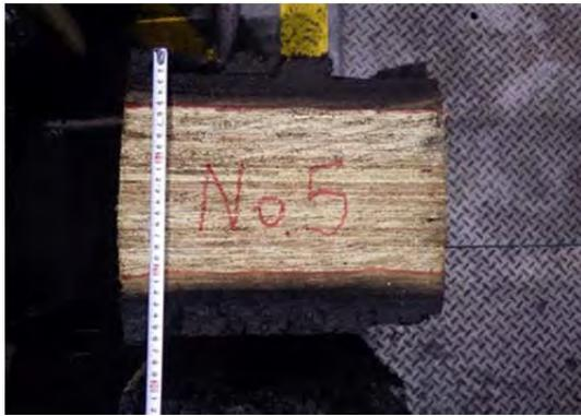
写真 5. 1. 3-15 試験体③-5 炭化状況
