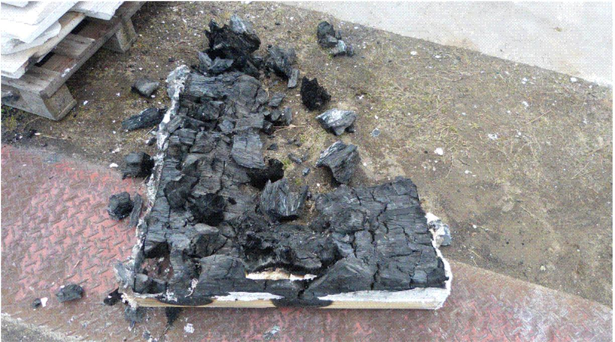
写真 21 試験体 B-CS900PL-L (積層面加熱) における脱炉後の状況
