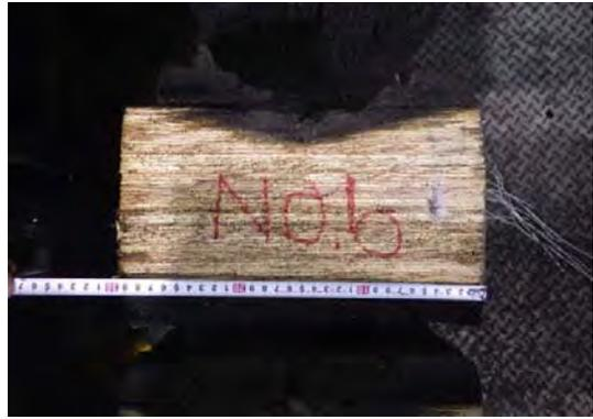
写真 5. 1. 3-16 試験体③-6 炭化状況
