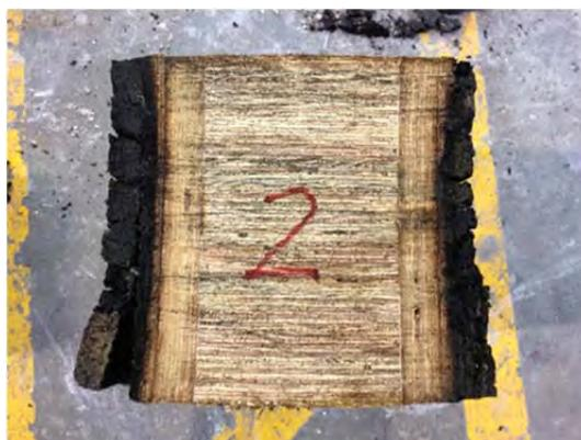
写真 5. 1. 3-6 試験体①-2 炭化状況
