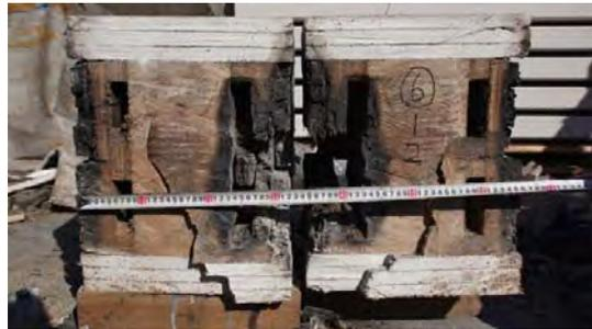
写真 5. 1. 3-18 試験体⑥-2 炭化状況
