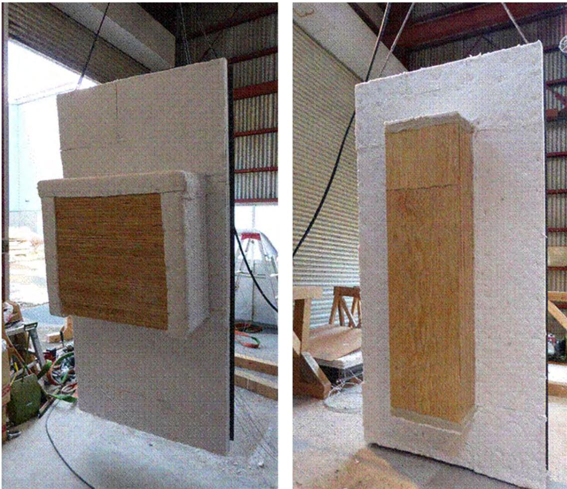
写真 16 耐火炉に取り付ける枠に設置された試験体（左：梁、右：柱）
