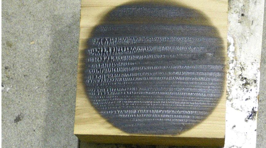
写真3 柁目に近い材の燃焼(1)初期
