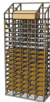
図 2 構造用単板積層材を床版として採用した建築例(左:流山おおぐろの小学校、右:ノルウェーのミヨサタワー)
