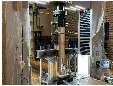
図 5 ビス接合部試験
