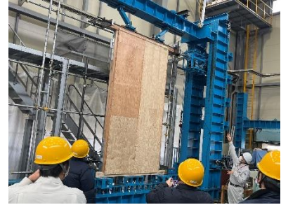
図 6 実大サイズせん断試験
