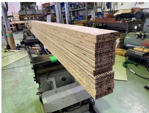
図2 昨年度製造・開発したハイブリッド LVL (内層スギ LVL 外層カラマツ LVL)
