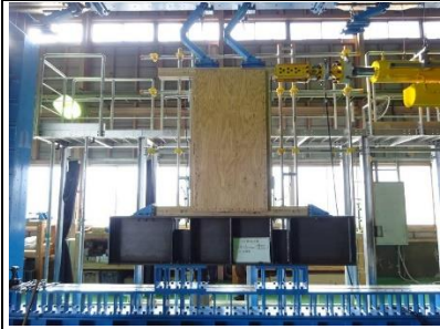
図 4 面内せん断試験（詳細計算）
